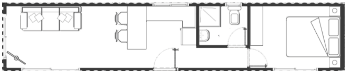
12m x 2.44m 1 dormitorio, cocina integrada al estar, barra desayunador y baño completo
